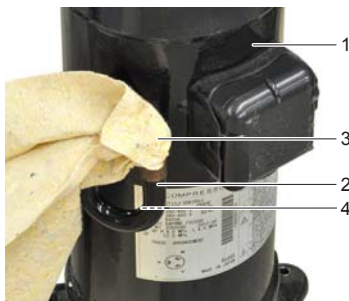
Figure 105 - Installation d'un compresseur neuf - 2
